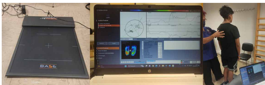
FIGURA 2. Evaluación estabilométrica: plataforma barométrica, software FreeSTEP y momento de evaluación de uno de los sujetos.
