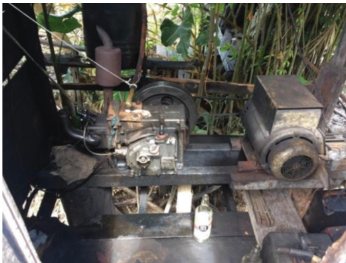
IMAGEM 2. Gerador de energia utilizado antes da energia elétrica antes da chegada da energia elétrica em ilha Araraim, Pará, Brasil.
