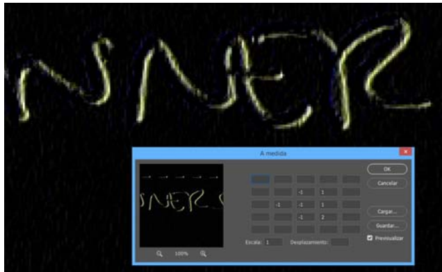
Figura 12. Matriz aplicada una imagen para la obtención de detalle e información del contorno.
