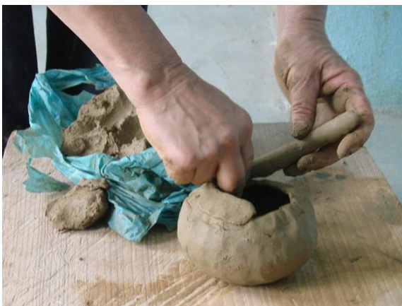
FIGURA 9. HACE ROLLOS DE BARRO, QUE PEGA A LA PIEZA PARA ACABAR DE DARLE FORMA EN EL PROCEDIMIENTO DE ELABORACIÓN
