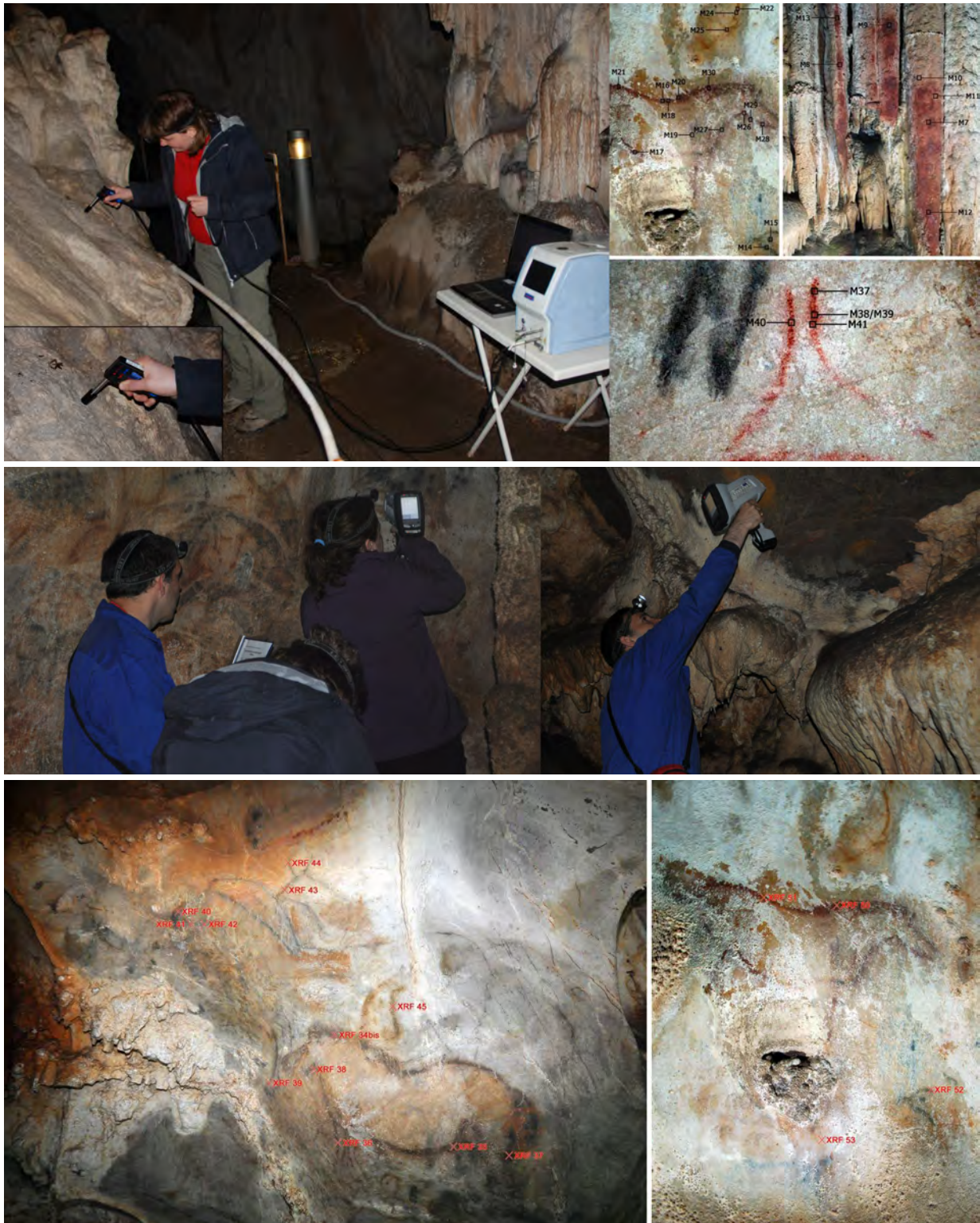
Análisis Raman: muestreo en zonas contaminadas de la Galería de la Entrada, en pinturas del Talud y los Discos (Gran Salón), y en la Sala Baja de los Signos (arriba). Análisis EDXRF: Gran Salón y afloramientos de mineral en la Galería de las Baticias (central); en el Camarín y el Talud (abajo) Raman analyses: Sampling in contaminated areas of the Galería de la Entrada, paintings of the Talud and the Discos (Gran Salón), and in the Sala Baja de los Signos (above). EDXRF analyses: Gran Salón and mineral outcrops in the Galería de las Baticias (central); in the Camarín and the Talud (below)
