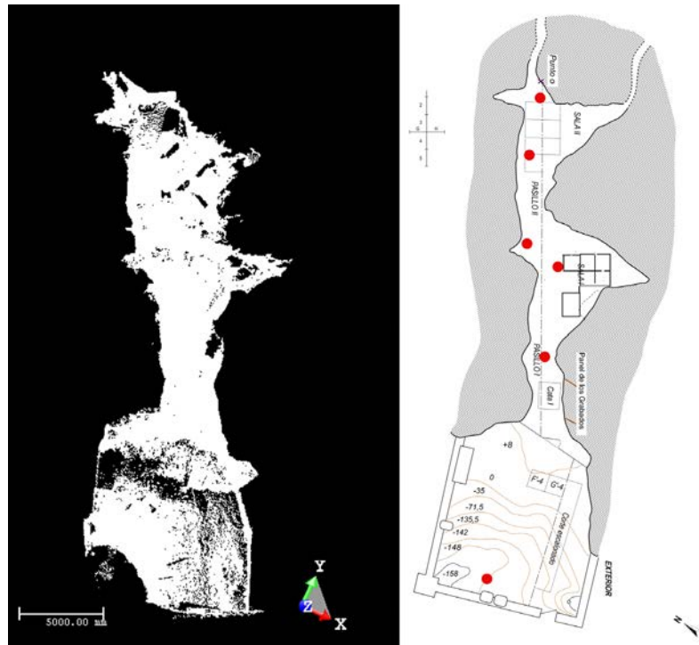
FIG. 4. Plano, en planta, de Las Caldas I: modelo láser (izda.) y plano vectorial (dcha.) con la ubicación de las estaciones láser para la documentación 3D de la cueva
