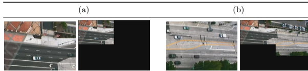
Figura 2. Ejemplo de generación de panorámica de un video de cámara PTZ. (a) y (b) se corresponden con los frames 6 y 339, respectivamente, mostrando la imagen captada por la cámara en ese instante y la panorámica elaborada hasta dicho momento.
