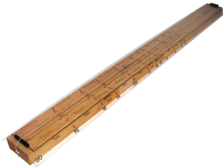
Fig. 6. Monocordio de 2/7 de coma sintónica según Gioseffo Zarlino. Dimensión 137 x 9 x 5 cms
