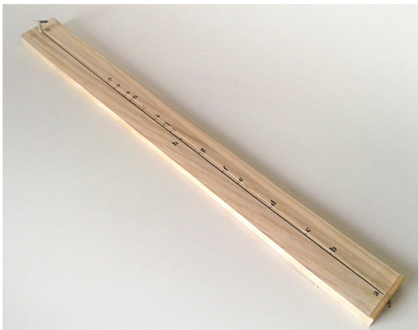
Fig. 3. Monocordio según Ramos de Pareja. Dimensión: 48 x 7 x 1,5 cms
