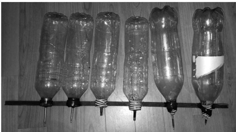
Figura 1. "Xilófono" fabricado con botellas de plástico cada una de ellas afinada en una frecuencia. Fuente: creación propia
