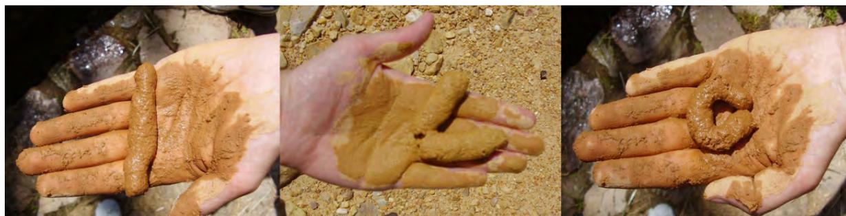
FIGURA 8. Pasos para realizar la prueba textural a un horizonte A de un suelo.
