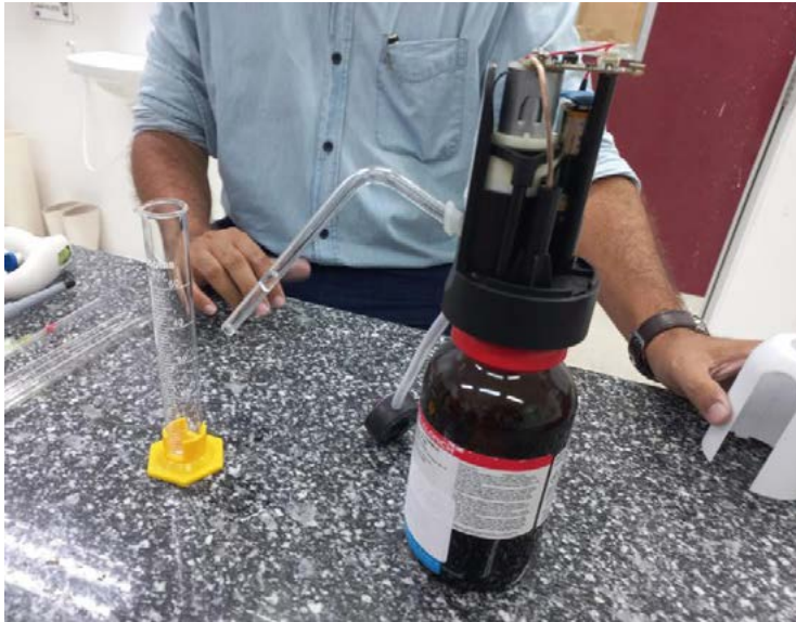
FIGURA 3. Dispensador automático de sustancias ácidas
