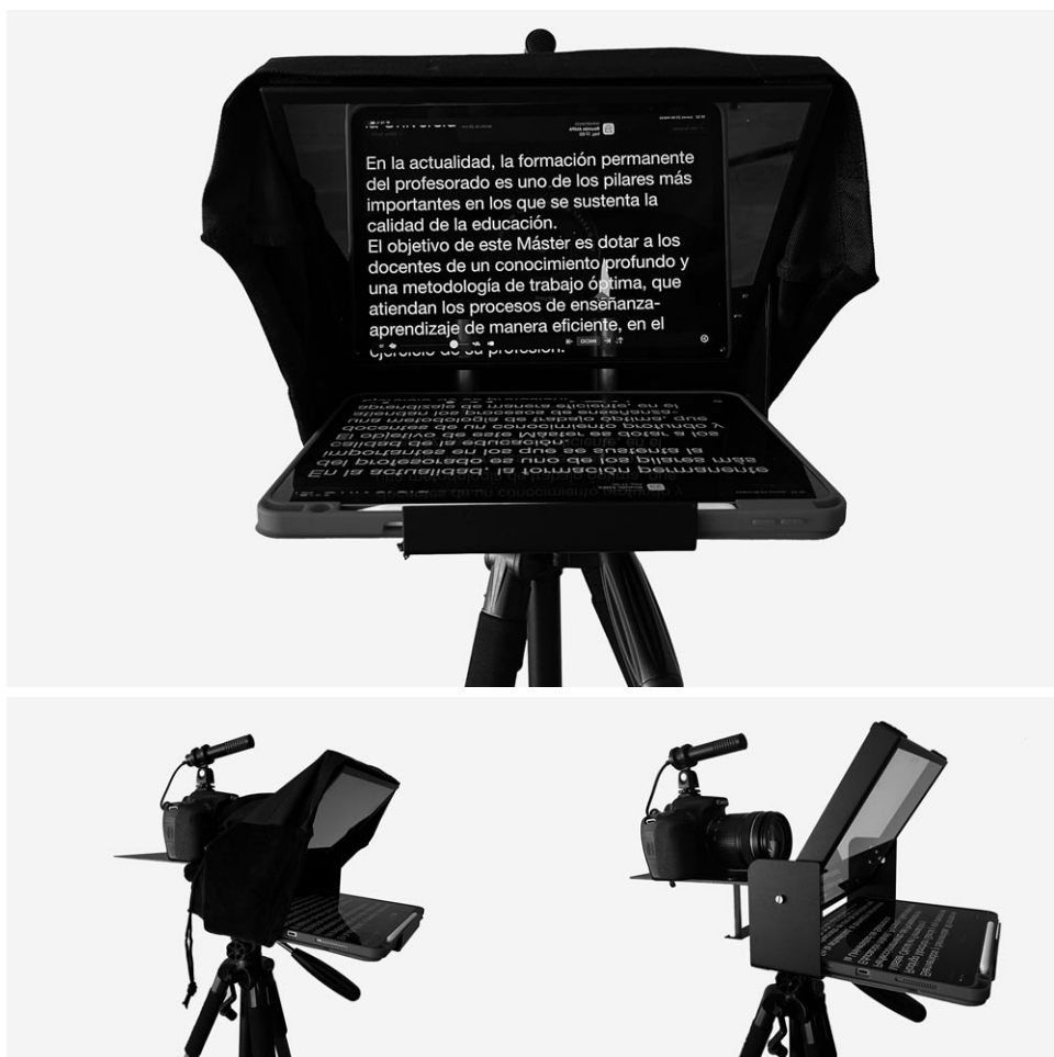
Figura 2. Teleprompter con cámara de vídeo y iPad incorporado para llevar a cabo la lectura de un guión durante la grabación
