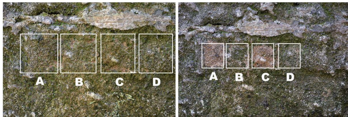
Figura 9. Aplicación de biocidas in situ sobre microorganismos, tras 7 (izquierda) y 15 (derecha) días. A, B y C corresponden a Preventol Ri80 , Biotin T y Biotin R , respectivamente. D es el control con agua destilada. Fotografías de Marta Sameño.
