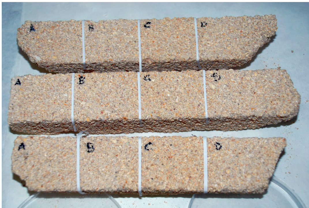
Figura 13. Probetas de piedra del Puerto para analizar el posible cambio de color producido tras someterlas a los distintos biocidas. Fotografía de Marta Sameño.
