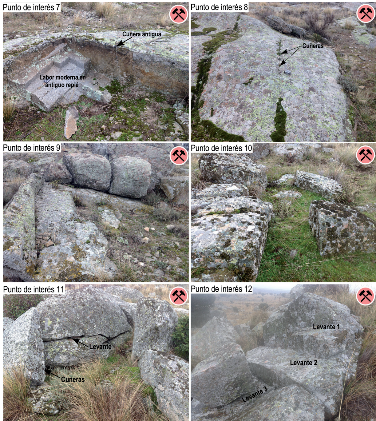
Figura 14. Puntos de interés de la zona de Alamedilla del Berrocal (Cerro Airón). Punto de interés 7. Antigua labor superficial con cuñeras y un repié que ha sido recientemente reutilizado. Punto de interés 8. Línea de cuñeras sobre un plano de diaclasa nortado con una continuidad de al menos 4 metros de longitud. Punto de interés 9. Pequeña cantera superficial antigua con un escalonado en la parte izquierda de la fotografía. Punto de interés 10. Pequeña labor antigua en la que se ha extraído un bloque (o varios) de ciertas dimensiones del granito fino equigranular. Punto de interés 11. Antigua labor en el granito de dos micas. Nótese el vaciado de material granítico de la parte central de la fotografía y la presencia de un bloque con cuñeras no aprovechado, en la parte izquierda de la fotografía. Punto de interés 12. Pequeña cantera escalonada antigua con varios levantes y bloques extraídos, pero no aprovechados, y cuñeras en el tercer escalón.
