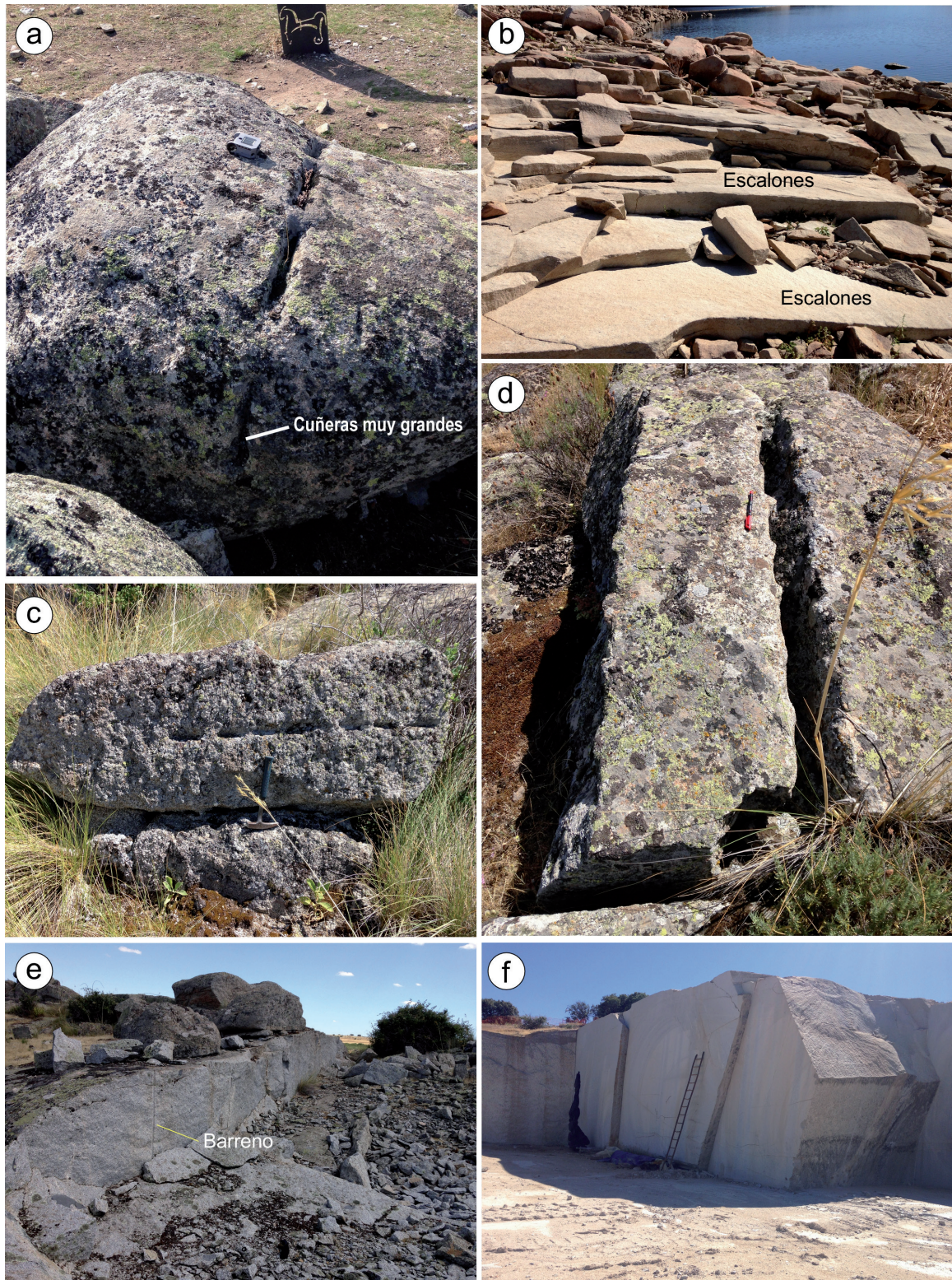
Figura 14. Evolución de las técnicas de corte en las zonas de estudio. a) Cuñeras de 30 cm en el granito grueso \pm porfídico biotítico en el Castro de las Cogotas, posiblemente para utilizar cuñas de madera. b) Labor superficial escalonada de la cual se extrajeron fácilmente bloques por el buen lajeado del granito fino biotítico. Estos bloques fueron utilizados en la muralla del castro de Las Cogotas. c) Cuñeras de unos 15 cm en un bloque cortado antiguo, de granito grueso \pm porfídico biotítico en Mingorría. d) Bloques antiguos de granito grueso \pm porfídico biotítico cortados con cuñas de unos 10 cm en Cardeñosa. e) Pequeño frente sin cobertera vegetal, marcas de barrenos y abundante material estéril de pequeñas dimensiones, aspectos típicos en las labores modernas de Mingorría y Cardeñosa. f) Cantera actualmente activa de granito grueso \pm porfídico biotítico donde el corte se hace con hilo de diamante (Cogotas).
