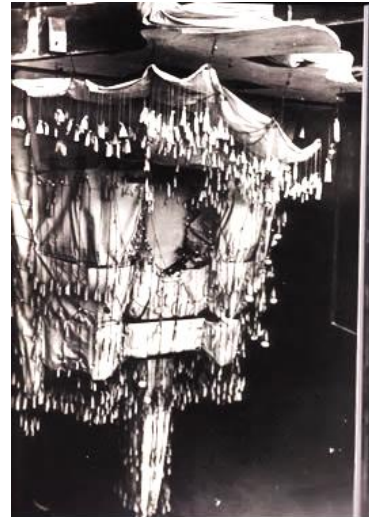
Fig. 181. Modelo funicular de la iglesia de la Colonia Güell. Fuente: GIRALT-MIRACLE, D. Gaudí. La búsqueda de la forma... , p. 99.
