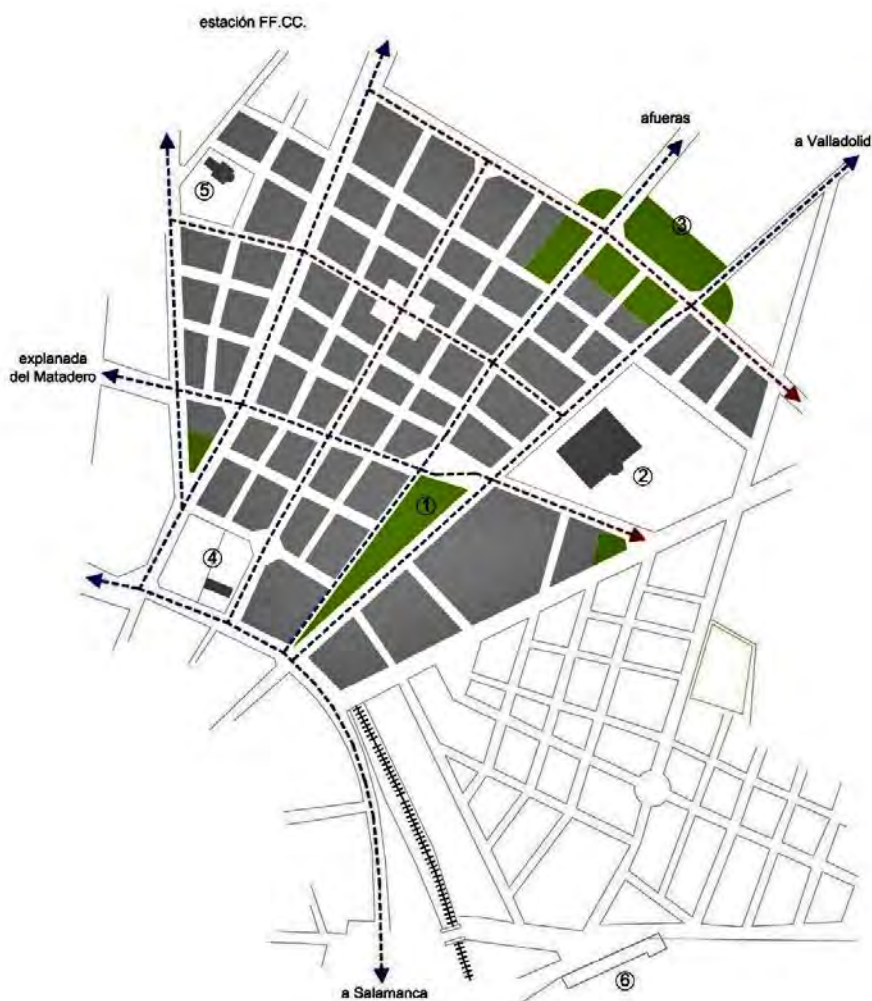
Figura 53. Esquema de la ordenación establecida para la zona central del ensanche, en el anteproyecto elaborado por Francisco Hernanz en 1929. En azul se indica la trayectoria de las vías estructurantes existentes; En rojo, los nuevos tramos y calles principales incorporadas en el planeamiento. El número 1 señala el paseo de las Glorietas, el número 2, el Instituto de Secundaria, el número 3 indica la situación del Cuartel de Caballería, el 4, la manzana donde se ubicaban los depósitos de agua municipales y las escuelas construidas en 1927 y el número 5 la ubicación de la iglesia de Lourdes. El número 6 señala el emplazamiento de la fundación de Candelaria Ruíz del Árbol.
