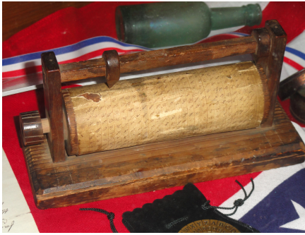
Figura III.2: Mecanismo de cifrado por Vigenère usado por el ejército Confederado en la Guerra Civil norteamericana (1865). Imágenes del National Cryptologic Museum (Wikimedia Commons).
