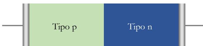
Figura IV.1: Esquema simple de un diodo.
