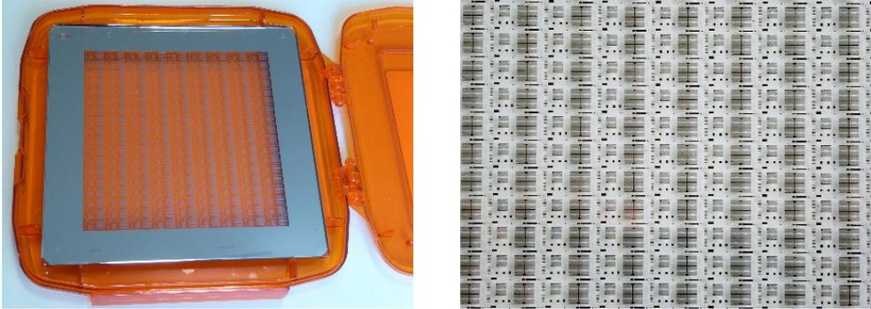
Figura XII.7: Máscara de litografía (izquierda) y detalle de la misma (derecha), donde se aprecian los patrones que se van a transferir al semiconductor. Como puede observarse, en la máscara existen patrones correspondientes a múltiples futuros chips (imagen cortesía de Tomás González Sánchez).
