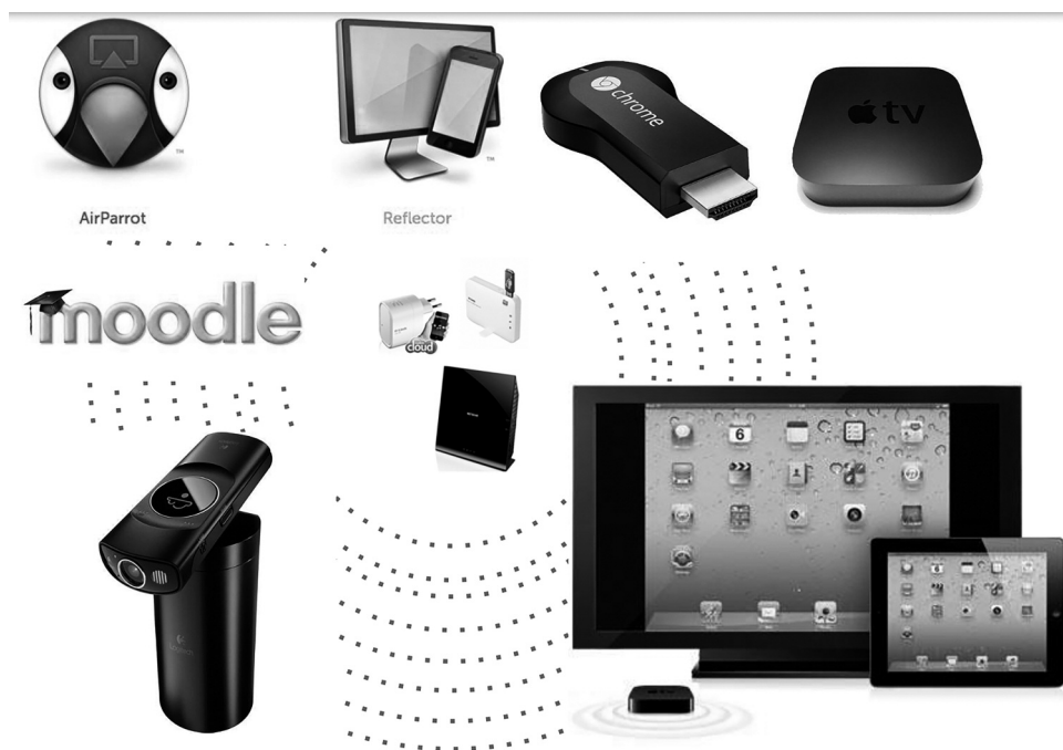
Figura 1. Esquema representativo del funcionamiento del Profesor HotSpot. La red privada generada por el router WiFi (centro) permite la conexión de diversos dispositivos y aplicaciones de software de uso restringido al aula o grupo de trabajo y bajo el control del profesor
