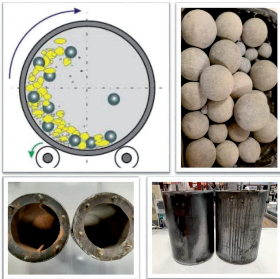
**Fig. 11:** Esquema de molino de bolas y prototipos a escala de los utilizados en el laboratorio de Ciencia de los Materiales de la Escuela Politécnica Superior de Zamora.
