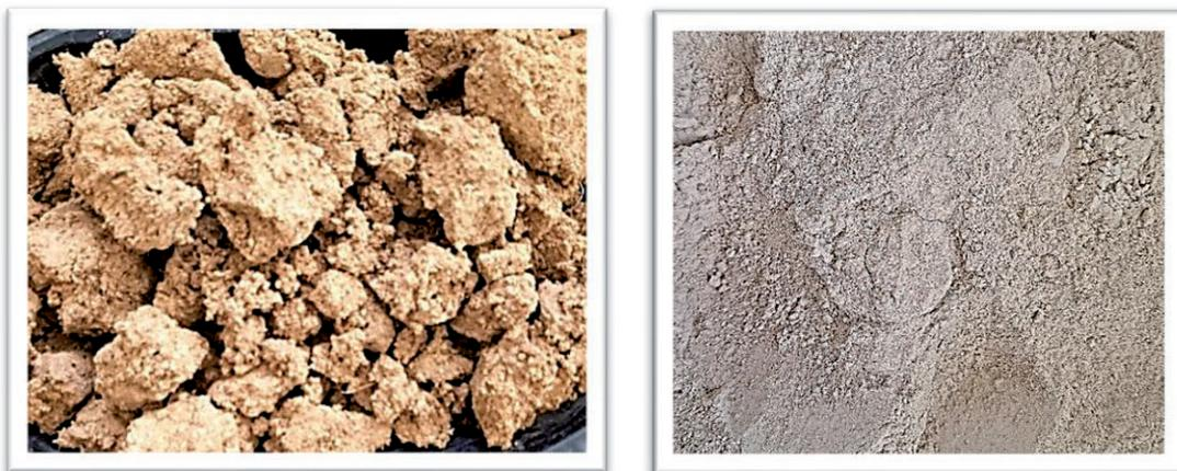
Fig. 164: Muestra de arcilla de Zamora antes (izda.) y después de la molienda.
