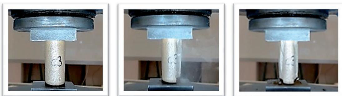
Fig. 137: Secuencia de rotura extraída de un video, fotograma a fotograma.
