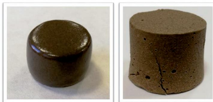
Fig. 120. Deformación por fase líquida (alta temperatura) y por el refractario (derecha).
