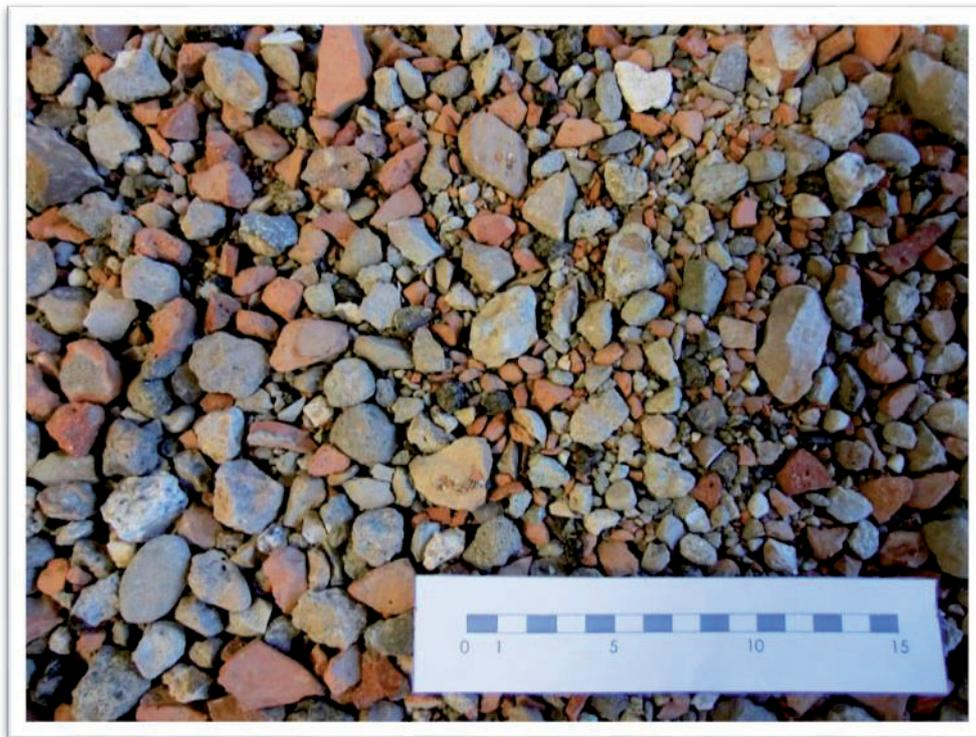
Fig. 27: Conjunto de la muestra de RCDs.
