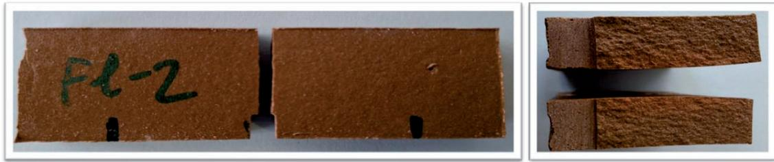
Fig. 143: Ejemplo de probeta fracturada y caras de fractura.
