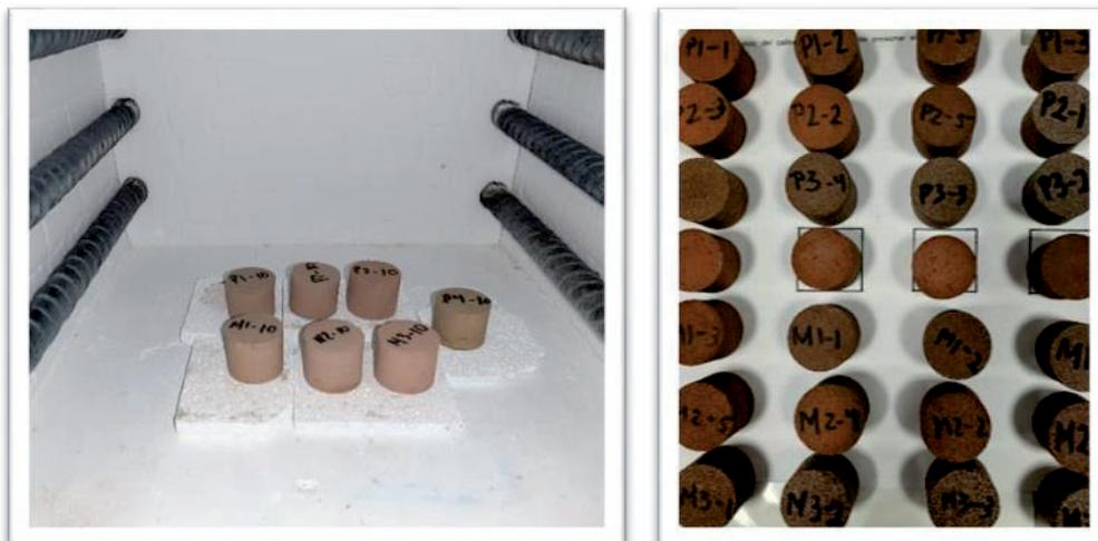
Fig. 48: Piezas de la mezcla de arcillas de Zamora con RCDs de 125 y 250 micras, conformadas por moldeo: (izq.) antes de la sinterización y (drcha.) después del proceso.
