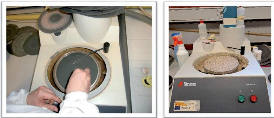
Fig. 49: Operación de desbaste en pulidora Struers.
