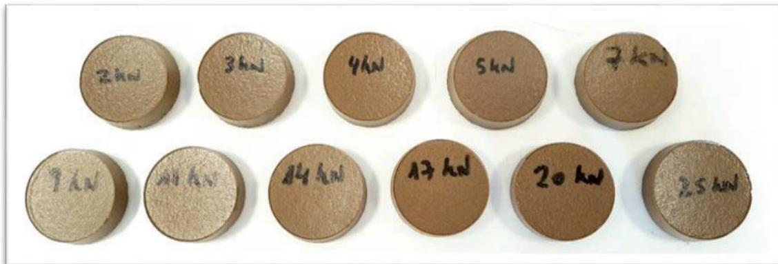
Fig. 107: Compactos sinterizados.
