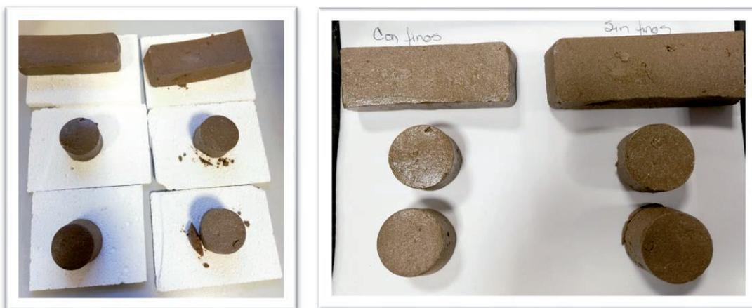
Fig. 123. Piezas sinterizadas a 1130°C, con finos (columnas izq.) y sin finos (columnas dcha.).
