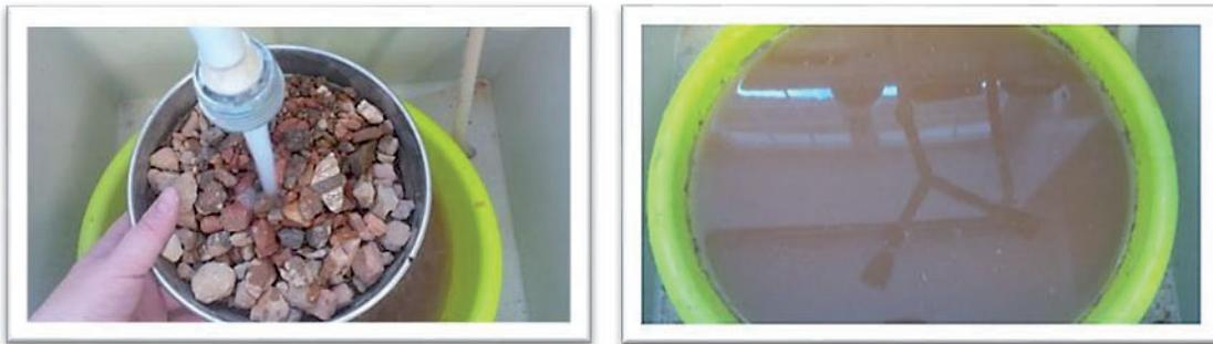
**Fig. 25:** Lavado por arrastre y restos de materia orgánica e impurezas.
