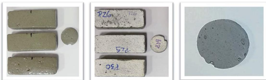
Fig. 125: Piezas sinterizadas a 1130°C con tonalidad verde: superior e inferior (centro), y sección. Esto podría deberse a que, al ser más porosas, el efecto de los vapores generados dentro del horno activó la densificación. Se observó un exceso de fase líquida con micro fusiones
