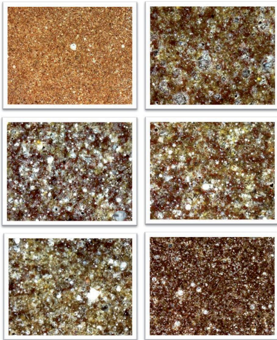
Fig. 94: Macrografías de las probetas sinterizadas (de izda. a dcha. y de arriba abajo): 1100°C, 1110°C, 1120°C, 1130°C, 1140°C y 1150°C.
