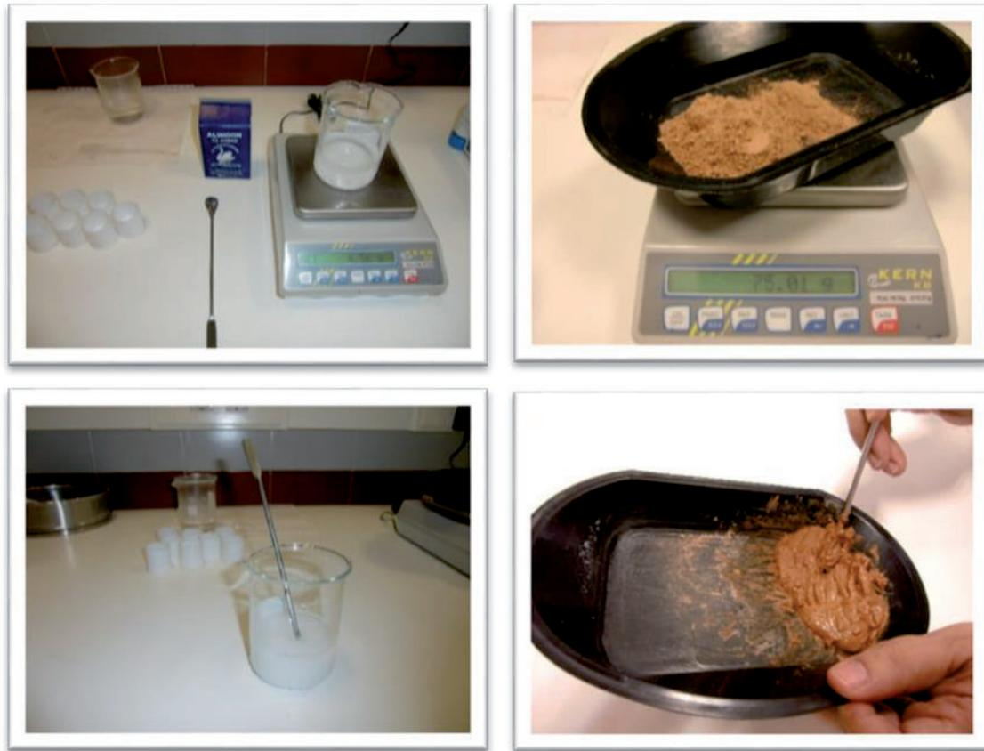
Fig. 35: Diferentes fases del conformado: pesado de almidón y de polvos, disolución aglomerante lista para ser añadida y mezcla residuos – aglomerante a humedad incipiente.
