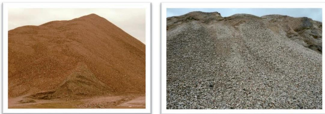
Fig. 2: RCDs reciclados como árido para firmes. CTR Roviña y San Gregorio.
