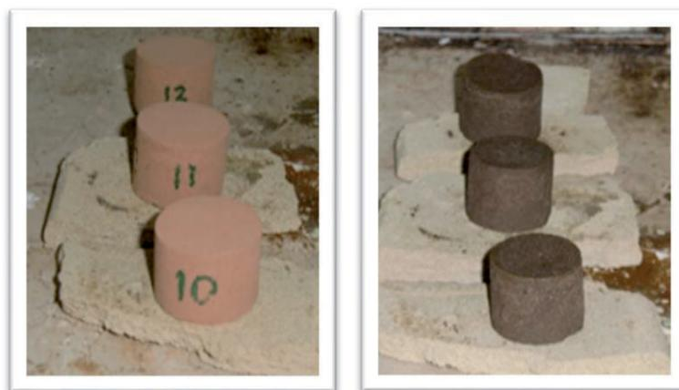
Fig. 46: Piezas conformadas por moldeo antes y después de la sinterización.
