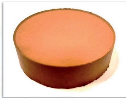
Fig. 104: Disco en verde fabricado por compactación uniaxial.
