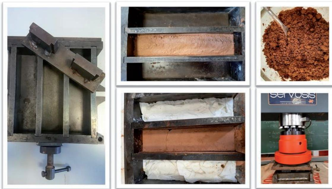
Fig. 39: Primeras pruebas para la optimización del proceso Starch aplicando presión.
