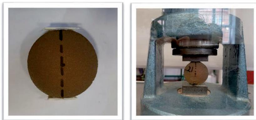
Fig. 56: Apoyos de madera y capilla multiensayo con los discos ceramicos.
