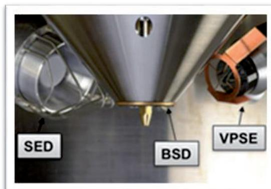
Fig. 68: Imagen de final de la columna donde se pueden observar tres tipos de detectores [134].
