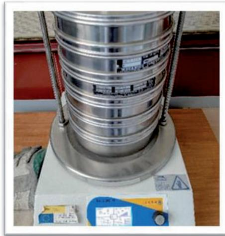
Fig. 31: Tamizadora automática marca CISA, modelo BA 200N y juego de tamices.
