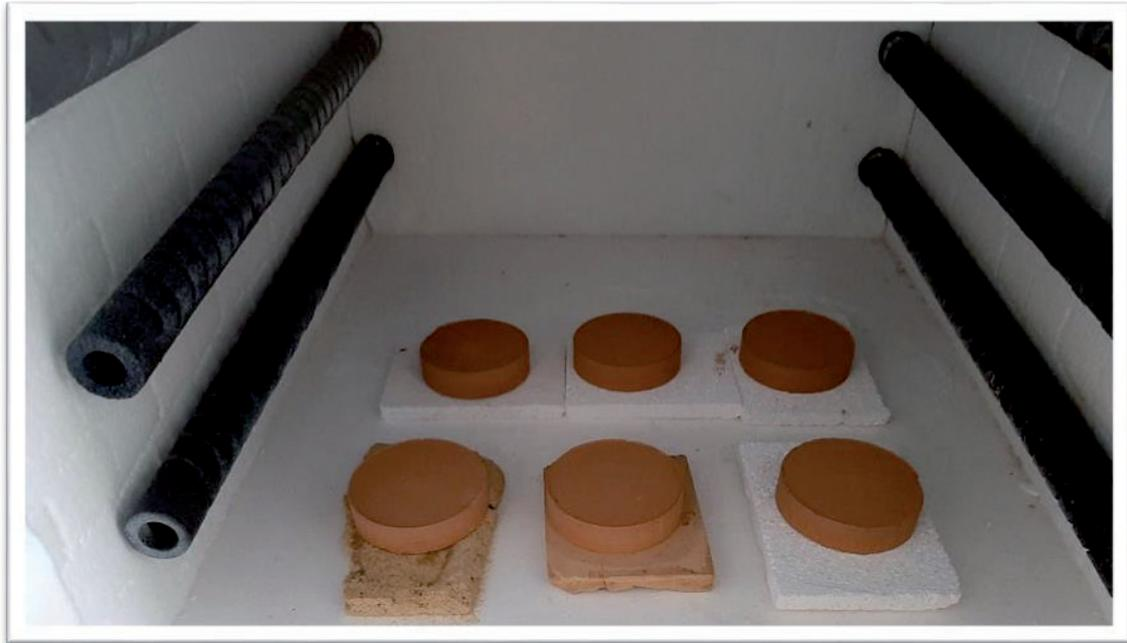
Fig. 45: Horno. Detalle de las resistencias de SiC y colocación de las piezas en verde.
