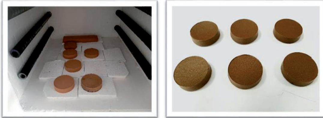
Fig. 47: Horno reformado (izq.) y piezas conformadas por compresión uniaxial antes y después de la sinterización (drcha.).
