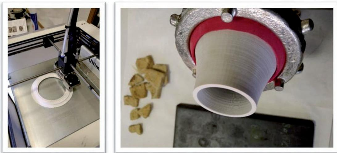
Fig. 38: Elaboración de boquilla mediante impresión 3D para extrusión de discos.
