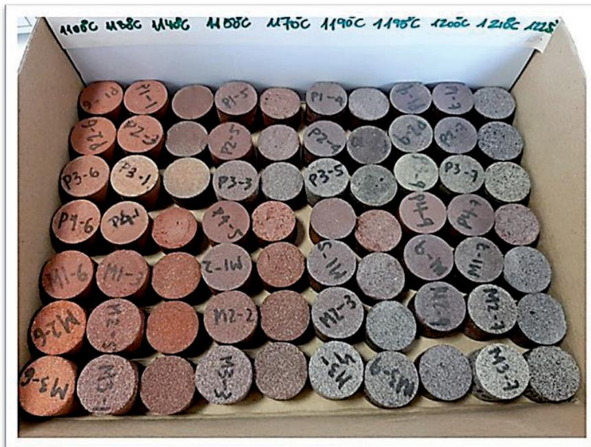
Fig. 167: Evolución volumétrica y colorimétrica de las probetas fabricadas.
