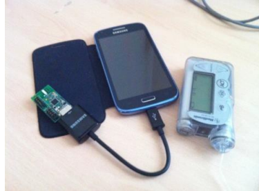
Fig. 6. Componentes del sistema de monitorización de glucosa.
