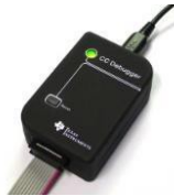
Fig. 4. Sistema de depuración y carga del transceiver RF-USB.
