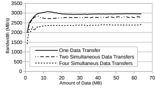
Fig. 4. Ancho de banda medio alcanzado en copias desde la memoria del host a la memoria de la GPU usando CUDA. Se muestran los anchos de banda medios para cada una de las transferencias individuales en los siguientes casos: una única transferencia, dos transferencias simultáneas y cuatro transferencias simultáneas.
