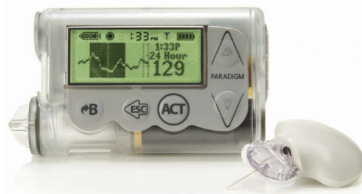
Fig. 1. Sensor CGM Enlite y bomba de insulina Medtronic Minimed 530g (fuente: www.diatribe.com).
