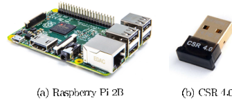
Fig. 3. Plataformas hardware para el nodo central y adaptador USB de radio BLE
