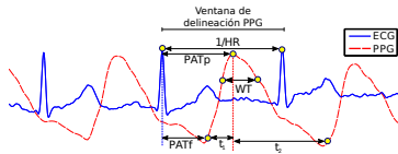
Fig. 2. Definiciones de tiempos para ECG y PPG.
